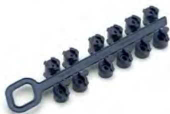
Árvore de bicos para os asp. 5000 Inclui oito de ângulo padrão (ângulo de trajectória de 25°) e quatro de ângulo baixo (ângulo de trajectória de 10°)
