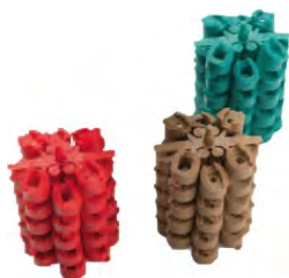
Bicos MPR para os asp. 5000 Distribuem a mesma taxa de precipitação entre os alcances do aspersor de 7,6 m a 10,7 m. (caudal proporcional à superfície a regar). Máxima flexibilidade no ajuste de setor minimiza os riscos de falta ou excesso de rega.
